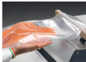
Utilizzo di buste goffrate per il vuoto fuori campana Embossed bags can be used to seal bigger products holding them outside the lid
