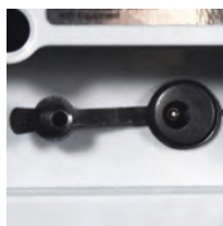
Proteção na entrada de alimentação
